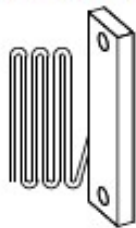
Contatto elettrico con cavo da 3 m o 10 m
